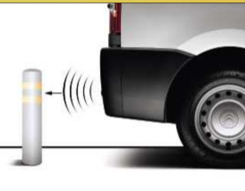
En option, sauf finition Confort, les radars de recul facilitent les manœuvres de stationnement. Lors du passage de la marche arrière, 4 capteurs radars implantés dans le bouclier arrière détectent les obstacles. Leur distance est signalée par une alerte sonore dont la fréquence s'accroît à mesure qu'ils se rapprochent, pour devenir continue lorsqu'ils sont à moins de 30 cm environ.
