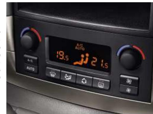
En option sur les versions Citroën Jumpy Atlante, le système de climatisation automatique règle de manière autonome l'ensemble des paramètres d'ambiance thermique de l'habitacle pour garder constante la température sélectionnée. Le réglage de toutes les fonctions est assuré à partir d'un tableau de commandes situé sur la planche de bord.
