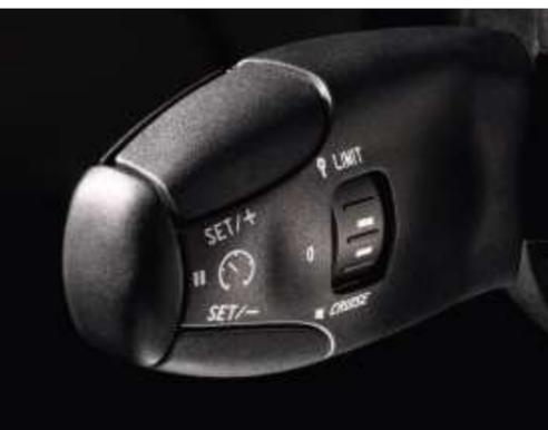
Disponible de série ou en option, le régulateur de vitesse permet de rouler à la vitesse de votre choix sans appuyer sur l'accélérateur. Une pression sur la pédale de frein annule la programmation. Le limiteur de vitesse, quant à lui, interdit de dépasser la vitesse choisie par le conducteur, sauf par action sur la pédale d'accélérateur au-delà de son point de résistance ou sur la commande d'annulation.
