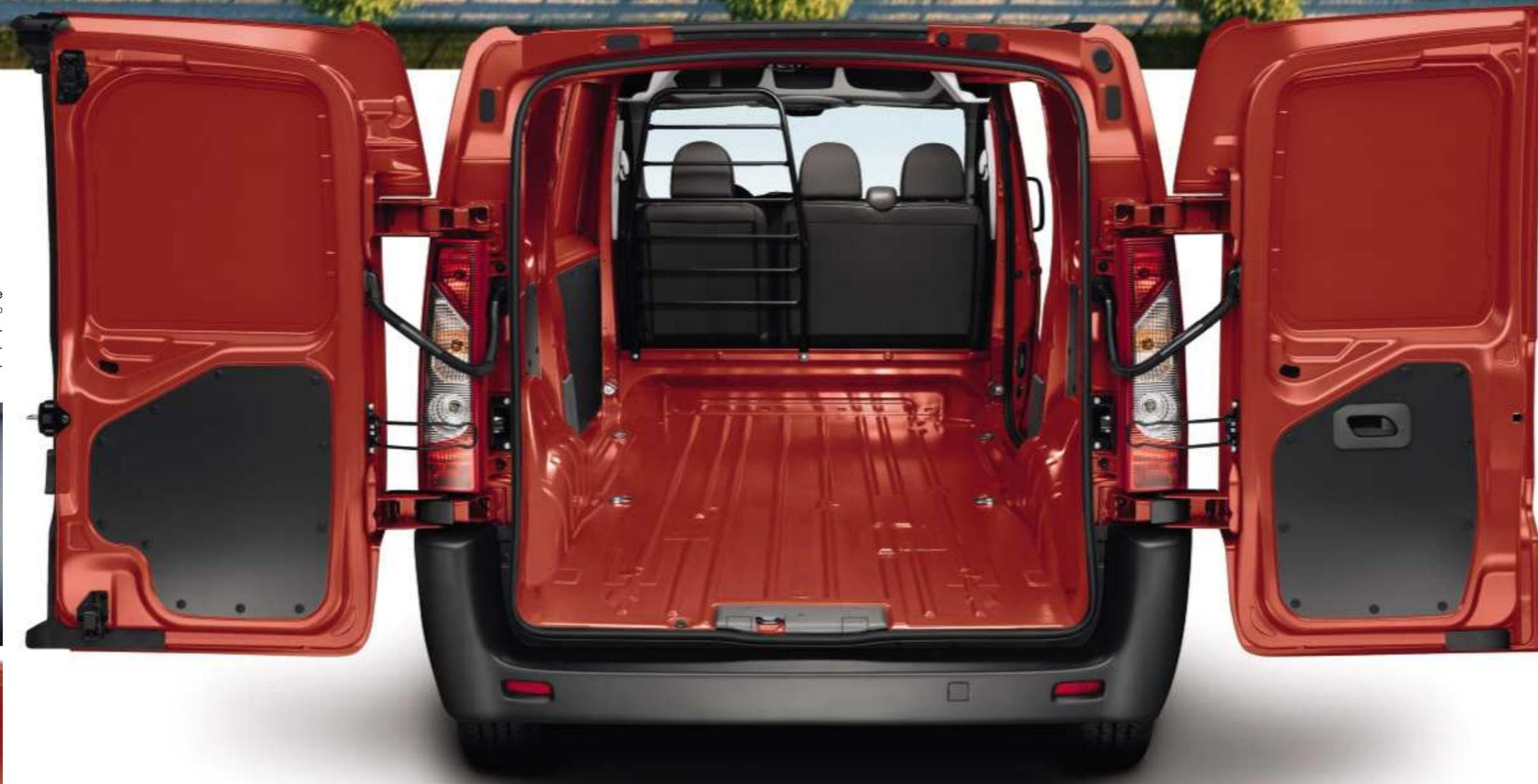
Tôlées ou vitrées, les deux portes arrière battantes s'ouvrent à 90° et jusqu'à 180° grâce à un système de tirant escamotable. Lorsqu'elles sont vitrées, elles peuvent être équipées, en option, d'essuie-vitres et d'une lunette chauffante.
