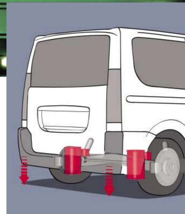
La suspension arrière à compensation pneumatique garantit une assiette constante dans toutes les conditions de charge ainsi qu'un meilleur confort pour les passagers et une tenue de route optimale. Ce système permet en outre de maintenir une hauteur constante inférieure à 1,90 m, soit en dessous du seuil standard minimal des entrées de parkings souterrains.
