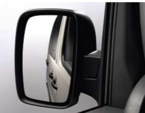
Les rétroviseurs extérieurs de Citroën Jumpy peuvent être dotés en option de commandes de réglage et de rabattement électriques implantées sur le panneau de la porte conducteur. Également en option, le dégivrage électrique des rétroviseurs latéraux est couplé à celui de la lunette arrière pour une vision optimale en toutes conditions (de série sur versions Club et Atlante).
