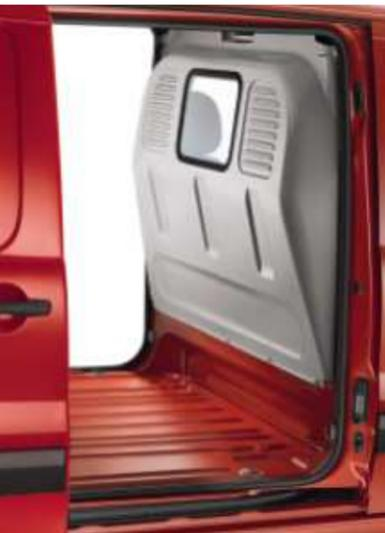
Le volume total de chargement de Citroën Jumpy varie de 5 à 7 m<sup>3</sup> selon la longueur et la hauteur du compartiment arrière, pour une charge utile de 1 000 à 1 200 kg. Selon les versions, la cloison de séparation entre la cabine et l'espace de chargement peut être tôlée ou vitrée.
